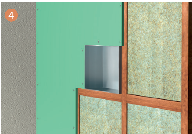
Die Trägerplatten können passgenau und flächenbündig rund um die Kanten der IN-BOX ADATTO angebracht und mit der Konstruktion verschraubt werden.
