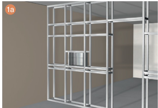
Die IN-BOX ADATTO in eine Holz- oder Trägerkonstruktion einpassen.
