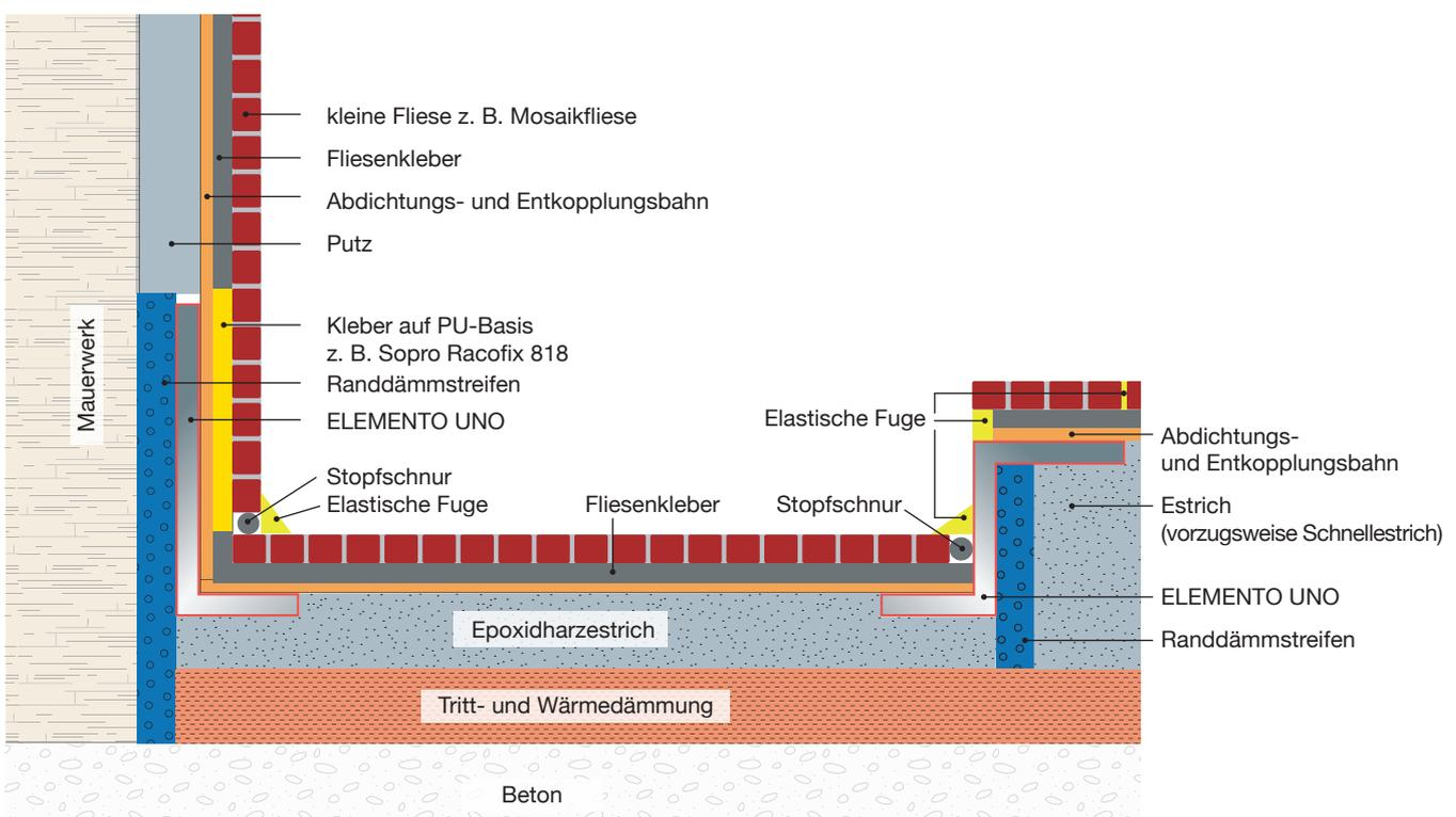
**6.** Schwellenloser Einbau ohne Spritzwasserschutz, durchgehende Fliese an der Schwelle zur Duschfläche \*
