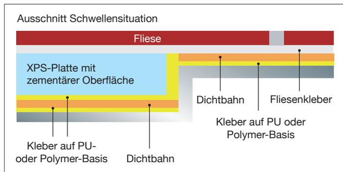
Empfohlene Materialien zum Einbau des ELEMENTO UNO (z.B. Sopro)
